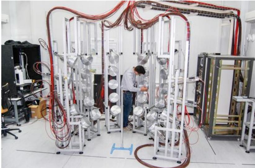
Detector de neutrones MODular Neutron SpectromETER - **MONSTER** desarrollado por el CIEMAT para la realización de experimentos de desintegración beta.
