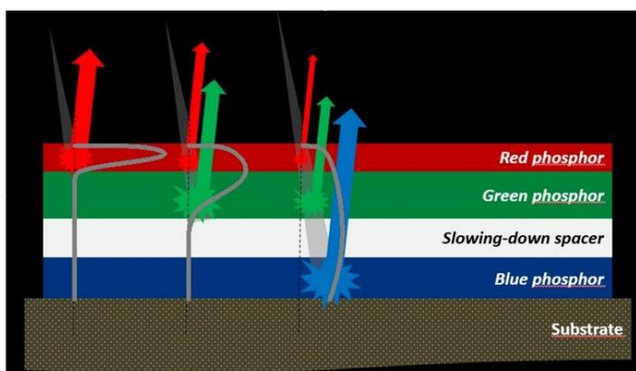
Un material luminiscente es aquél que emite en forma de luz, parte de la energía que se deposita en él. En el caso concreto del dispositivo desarrollado, cada capa luminiscente dentro del apilamiento consiste en una lámina de alta calidad óptica formada por óxidos transparentes dopados con tierras raras con una emisión luminiscente característica (un color emitido característico).
