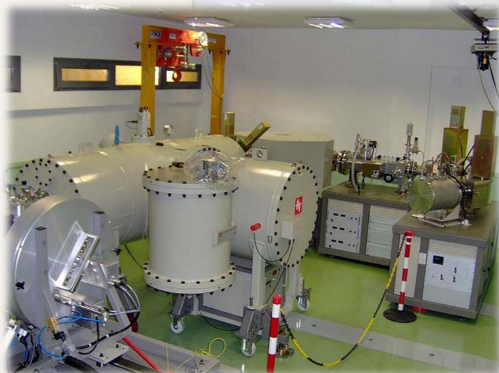
Acelerador Tandetrón 1 MV (AMS)
