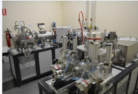
El sistema de AMS determina de forma precisa el cociente  $^{14}\text{C}/^{12}\text{C}$  de las muestras, para lo que mide los diferentes isótopos en distintas zonas del sistema. En la zona de baja energía mide la intensidad del haz de  $^{12}\text{C}$ . En la zona de alta energía mide la intensidad de los haces de  $^{12}\text{C}$ ,  $^{13}\text{C}$  y  $^{13}\text{C}$  procedente de la rotura de las moléculas de  $^{13}\text{CH}$ . Además, mide el número de iones de  $^{14}\text{C}$ .
